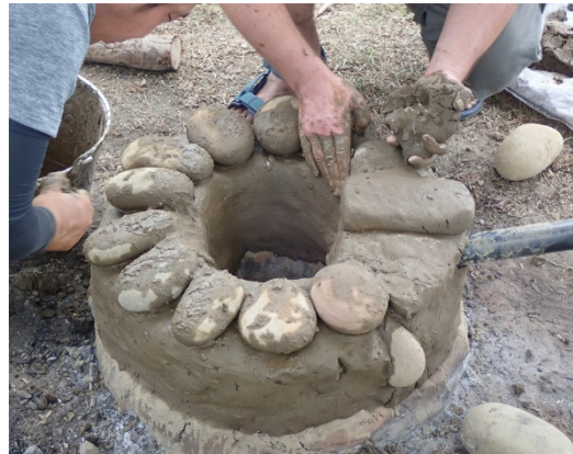
写真1 礫を使用した築炉の様子
