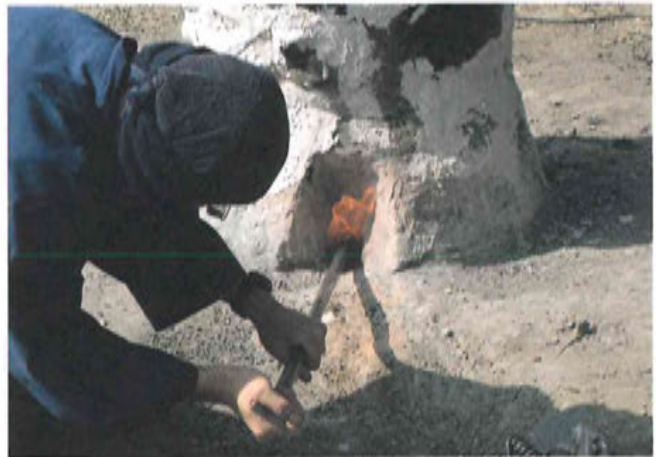
写真20 スラグ排出作業（本実験）
