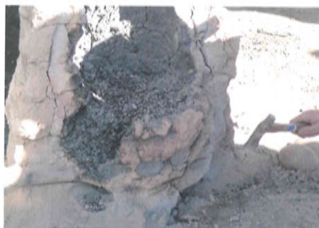
写真25 半截作業中の炉下部（本実験）
