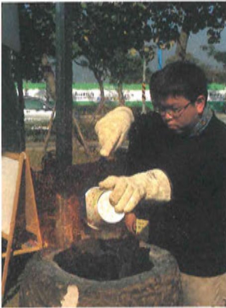
写真17 炉内への砂鉄投入（本実験）
