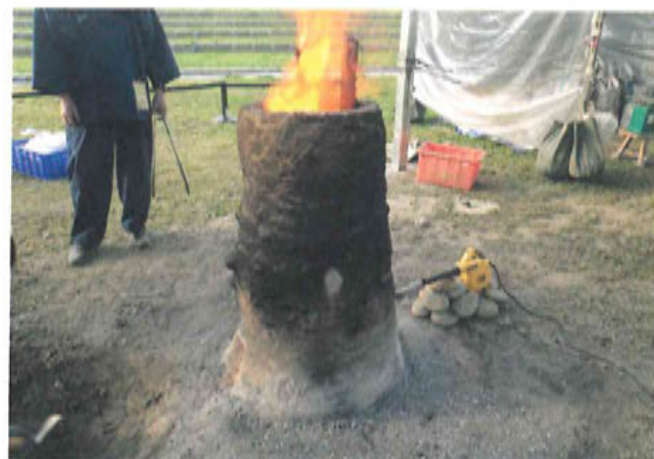
写真15 炉への送風状況 (本実験)
