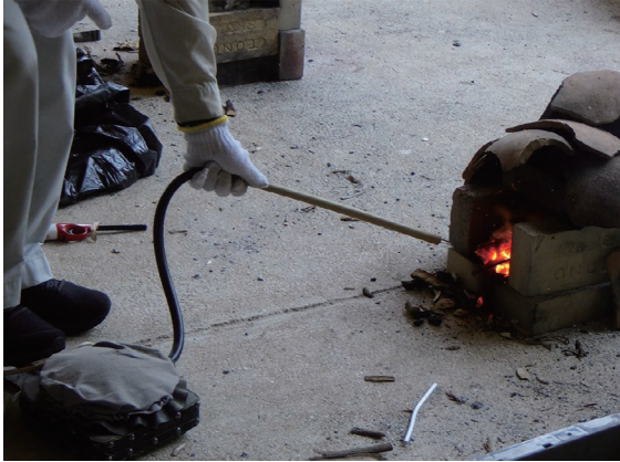
写真 5 轆で火力を調整する様子
