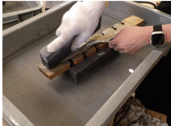
写真 8 砥石で磨く作業
